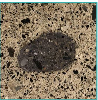
O resultado do vinho tinto deixado em uma superfície de concreto polido por 24 horas. O vinho tinto deixou uma mancha bem visível.
